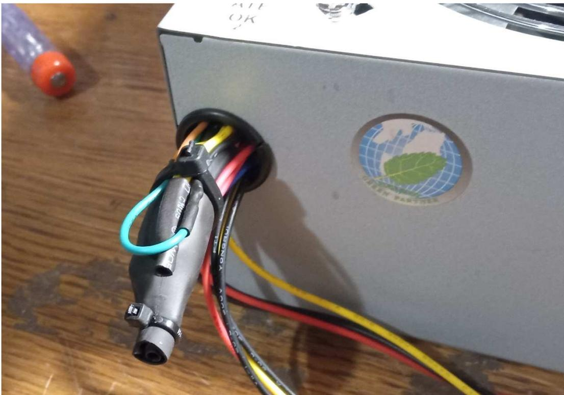
Pigtail (vorkonfektionierter Stecker mit Kabel) an die Stromleitungen anlöten. Auf saubere Lötungen achten!
