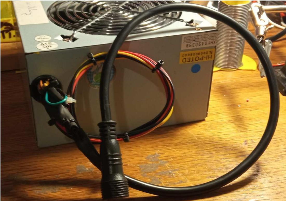
Hier wurde zusätzlich die 5V-Stromversorgung des PC-Netzteils verwendet, um den Spannungswandler vom Arduino zu entlasten. Dabei werden die 5V direkt in den 5V-Eingang des Arduinos eingespeist:
