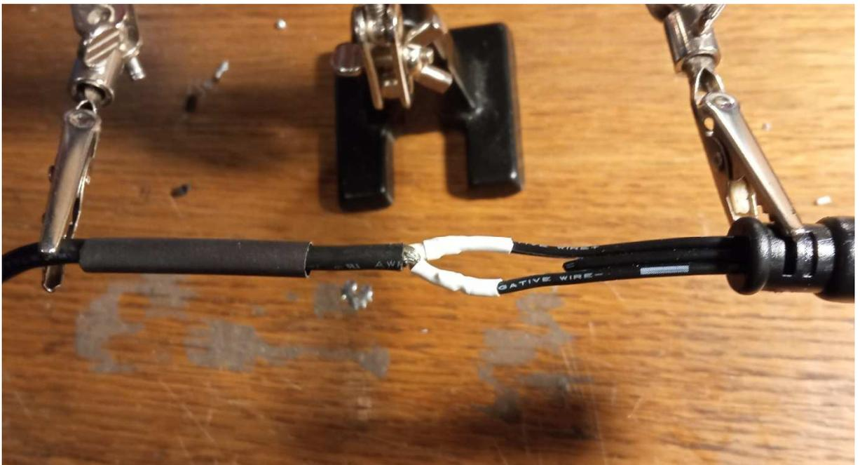
Anlöten des Steckers an das Kabel eines Netzteils; sowohl beide Adern als auch Außenmantel mit Schrumpfschlauch isolieren! Signalleitung (Leitung in der Mitte) abknipsen
