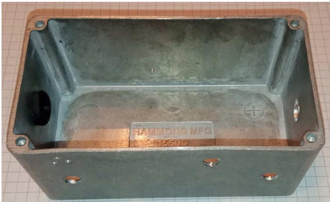
vorbereitetes Gehäuse; ein Kabelführungs-Gummi bereits montiert
