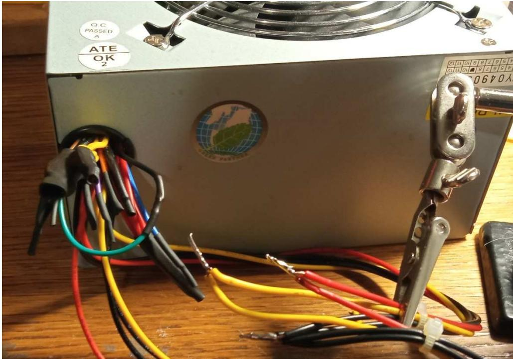
Leitungen nach Farbe sortieren, Schrumpfschlauch drüber, dann über alle Kabel-Pakete nochmals einen dicken Schrumpfschlauch und das Ganze noch mit Kabelbindern vollenden:
